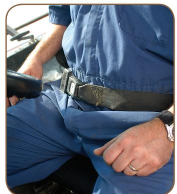
Usar un cinturón de seguridad en tractor con estructura de protección contra vuelco
