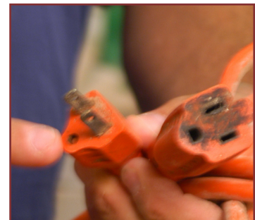
Plug with missing prong Tapón con dientes faltantes
